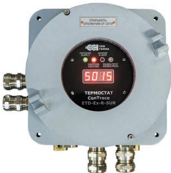
Электронный термостат ConTrace ETD-Ex — одноканальный взрывозащищенный прибор, предназначенный для управления электрообогревом путем включения/выключения подключенной к нему нагревательной секции в зависимости от температуры обогреваемого объекта, которая измеряется подключенным к термостату датчиком температуры.
