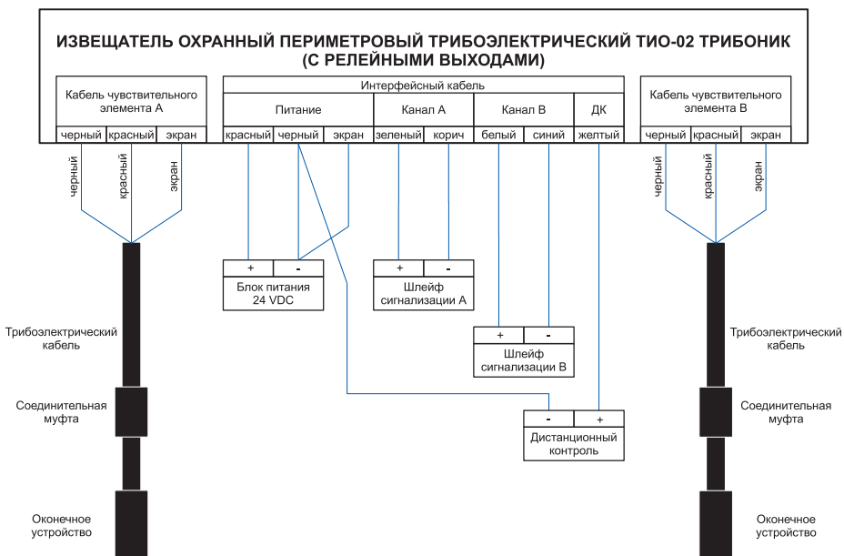
Рисунок 4 – Схема подключения извещателя в варианте исполнения с релейными выходами
